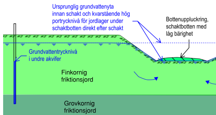
Figur 2-4. Vid schaktning i vattenmättad finkornig friktionsjord finns risk för hydraulisk bottenuppluckring direkt efter schakt p.g.a. att jorden under schaktbotten har en kvarstående porvattentrycknivå motsvarande grundvattenytan före schaktning.
